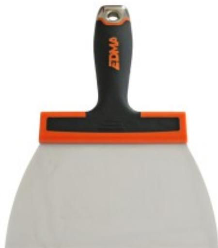
Lama in acciaio inossidabile di 0,5 mm di spessore. Lama curva che si appoggia sulla superficie da lavorare. Rinforzo per irrigidire la lama su tutta la sua larghezza. Manico in bi-materiale con testa in metallo.
