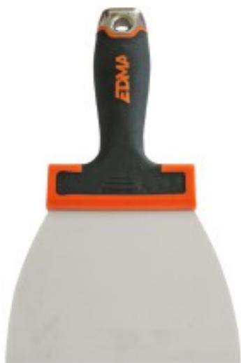
Lama in acciaio inossidabile di 0,5 mm di spessore. Lama curva che si appoggia sulla superficie da lavorare. Rinforzo per irrigidire la lama su tutta la sua larghezza. Manico in bi-materiale con testa in metallo.
