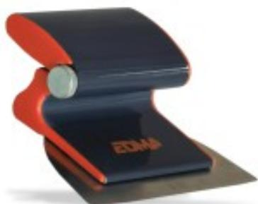
Permette di lisciare il composto, il nastro per i giunti, l'intonaco. Impugnatura regolabile in 2 posizioni per adattarsi alla superficie di lavoro. Facile da usare grazie alla sua struttura leggera ed ergonomica. Adattabile alle aste telescopiche EDMA (impugnatura e aste non incluse). Lama in acciaio inossidabile con bordi arrotondati per un risultato senza striature e senza perdita di composto. Spessore della lama : 0,3 mm.
