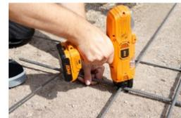
Leggero e compatto. Consente la legatura delle armature in modo rapido, efficiente e senza sforzo. Forza di serraggio regolabile in base alle dimensioni del ferro legante. Uso di bobine di filo da 100 m. Esiste in 2 dimensioni: Ref. 367655. 24 mm Circa 280 legature / bobina. Capacità di legatura: Ø maglia da 12 a 24 mm. Consegnato con: - 1 rocchetto di filo 100 m. - 2 batterie 14,4 V - 2 Ah. - 1 caricatore doppio. - 1 pinza da taglio. - 1 chiave a brugola. - 1 valigetta di trasporto.
