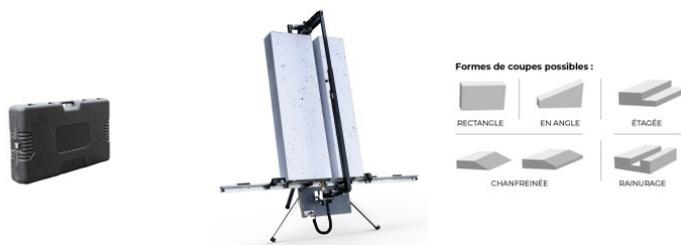
taglio netto senza proiezione di perle di polistirene. Per polistirene espanso ed estruso (E.P.S. e X.P.S.). altezza di taglio regolabile da 810 a 1400 mm. Profondità max. 320 mm. Trasformatore: 42 V / 240 W / 230 V. certificato CE. Accessori inclusi: - Custodia di trasporto - 2 rulli di fili ALTEZZA DI TAGLIO REGOLABILE. Già assemblata. Forme di taglio possibili: rettangolare, ad angolo, a scalini, scanalatura, smussata.
