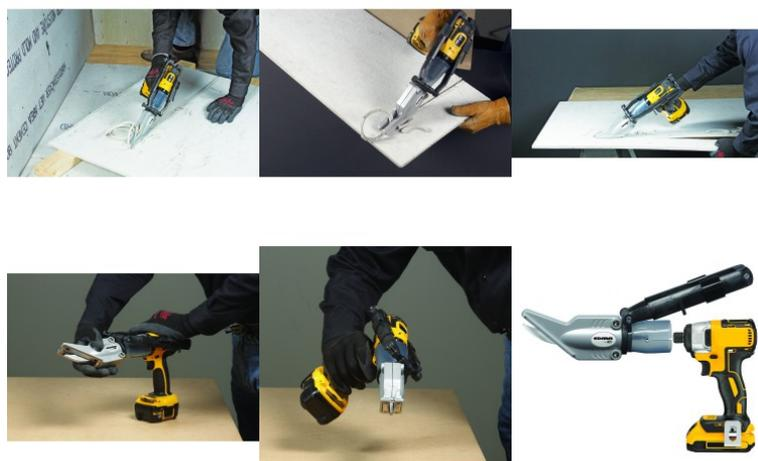
Per il taglio pulito e senza sforzo di pannelli in fibrocemento (tipo Aquapanel® Outdoor). Adatto a tutti i tipi di trapani/avvitatori (a partire da 14,4 V). : 12,5 mm. Genera pochissima polvere. La testa può essere ruotata di 360° per poter scegliere la posizione di lavoro più adatta in base alla configurazione di taglio.
