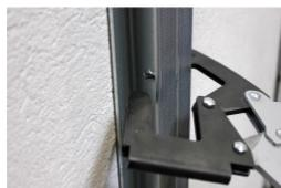
Facile da usare e risparmio di tempo. Grande apertura per punzonare i profili schiena contro schiena in un colpo solo. Punzone con larghezza 90 mm. Max. Capacità: 1 + 1 mm.
