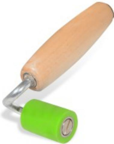
Design ergonomico che permette di appoggiare la mano con la massima pressione sull'impugnatura, senza alcun dolore al polso. Doppi cuscinetti a sfera. Per la saldatura di listelli di copertura. Rulli in silicone. Ø 33 mm.
