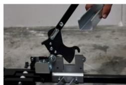
Permette di tagliare profili da 48 mm , profili F530, barre filettate da Ø6 mm e filo metallico Ø 4 mm. Ideale per l'installazione del muro a secco o controsoffitti. taglio netto = bullonatura immediata. Nessun rumore. Niente scintille - nessun rischio di incendio - Nessun permesso speciale. 545 mm, guida di taglio regolabile può essere posizionata a destra o a sinistra. Fino a acciaio 6.6 dolce: 60 kg/mm<sup>2</sup>. Non può tagliare acciaio inossidabile.
