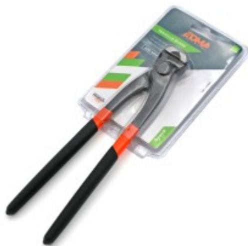
Utensile forgiato in cromo-vanadio (CrV). Ganasce da 55-61 HRC. Bracci da 42-48 HRC. Ganasce indurite a induzione per un maggiore rendimento. Impugnature con immersione in PVC antiscivolo.
