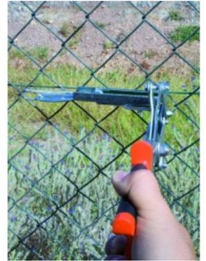
Fissaggio perpendicolare. Per rete metallica e rete in corda. massimo fissaggio  $\varnothing$ : 3,9 + 3,6 mm (rete metallica + filo di tensione). Caricatore da 50 punti. Compatibile con OMEGA 20
