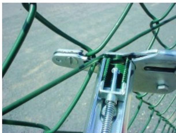
Fissaggio perpendicolare. Per rete metallica e rete in corda. massimo  $\varnothing$  fissaggio: 2,1 + 2,2 mm (rete metallica + filo di tensione). Caricatore da 50 punti. Compatibile con OMEGA 16.
