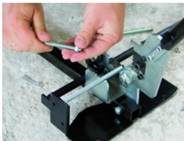
Taglio netto senza bave = bullonatura immediata. Nessun inquinamento acustico. Consente inoltre di stampare a stampo le barre filettate danneggiate. Non produce scarti (nessuna limatura di acciaio). Permessi antincendio non necessario in aree sensibili perché nessuna scintilla. Max. : acciaio dolce 6.6 (60 kg/mm<sup>2</sup>) Non taglia aste in acciaio inox Fermo di regolazione da 545 mm posizionabile a destra oa sinistra.
