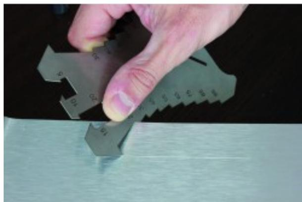
Dima di tracciatura in acciaio inox Graduazioni da 5 a 100 mm (da 5 a 5 mm).
