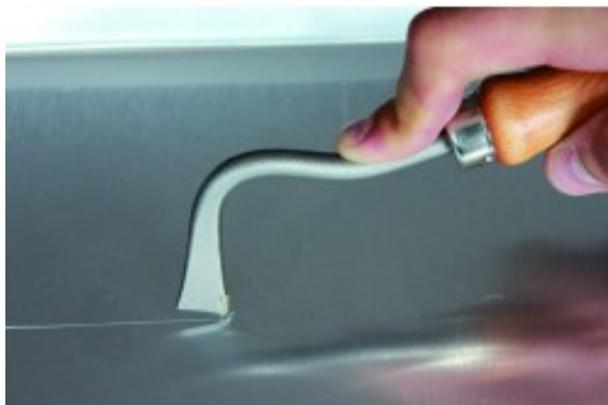
Punta in metallo duro. Punta estremamente resistente. Piegatura, taglio e marcatura di lastre di zinco e laminati.
