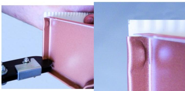
Fissaggio forte e veloce. Capacità: - 0,8 mm: zinco, alluminio.- 0,75 mm: lamiera. Crimp 6 x 3 mm. Utilizzare per grondaie in zinco e alluminio, strisce perimetrali Profondità da 5 a 20 mm.
