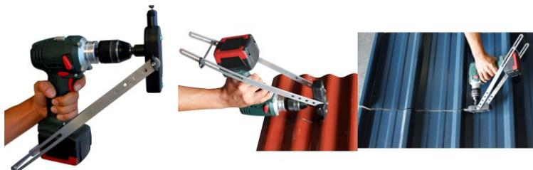
"Taglio netto e rapido. Capacità di taglio:- 0,8 mm: acciaio inossidabile.- 1,5 mm: acciaio zincato, zinco, lamiera, rame, ottone.- 2 mm: PVC, pavimenti in vinile, alluminio.- 2,5 mm: policarbonato. Potenza attacco per trapano per superfici piane o grecate in metallo e PVC. Velocità minima 300 giri/min. Matrice multidirezionale.
