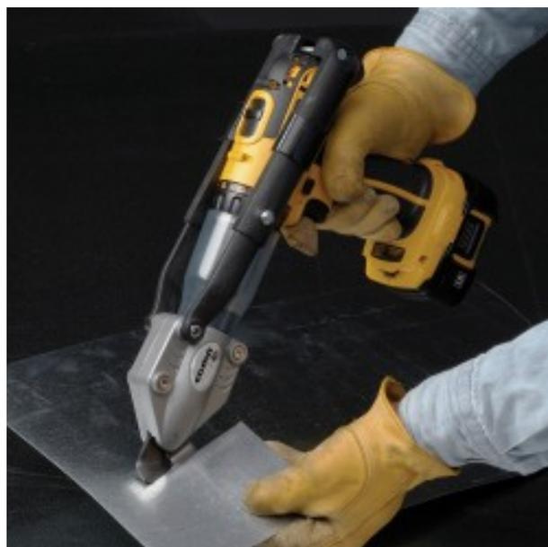
Taglio pulito, veloce e senza sforzo. Capacità di taglio: - 0,9 mm: acciaio inossidabile.- 1,5 mm: galva, rame.- 2 mm: alluminio. Per tutti i trapani/avvitatori da 14,4 V e 2 Amp minimo. Facile da tagliare con una mano. Può essere utilizzato in entrambe le direzioni.
