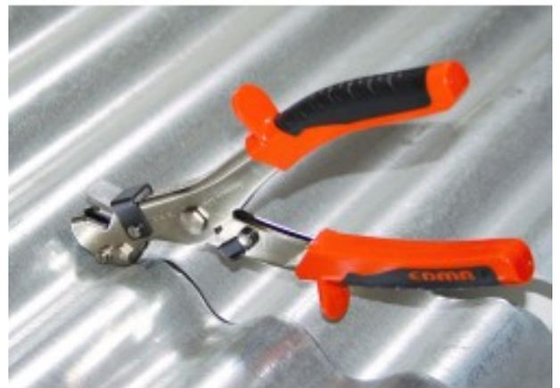
Speciale per lamiera ondulata. Capacità di taglio:- 0,6 mm: acciaio inossidabile.- 1,2 mm: acciaio zincato, zinco, lamiera.- 2 mm: PVC, pavimenti vinilici, alluminio.
