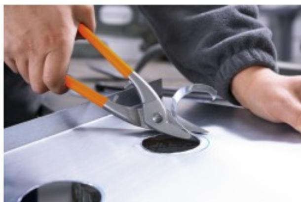
Acciaio al carbonio. Capacità di taglio :- 1 mm : acciaio inossidabile.- 1,5 mm : lamiera zincata, zinco. Per tagli dritti e curve corte. Lunghezza lama: 42 mm. Lame da 56 HRC a lunga durata. Manici con rivestimento in PVC (isolamento termico).
