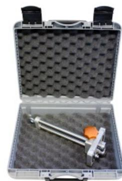
Adatto per realizzare pieghe, contropieghe e rialzati su parti curve e circolari. Risparmio di tempo rispetto all'utilizzo di pinze per bordi. Capacità di curvatura:- Acciaio inox: 0,5 mm.- Acciaio/lamiera morbida: 0,7 mm.- Rame : 0,8 mm.- Zinco/alluminio: 1 mm. : 200 mm.
