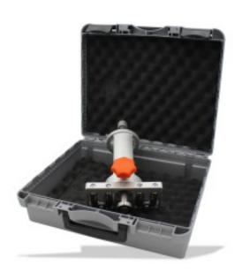
Adatto per realizzare pieghe, contropieghe e rialzati su parti curve e circolari.Risparmio di tempo rispetto all'utilizzo di una pinza per bordi.Capacità di piegatura:- Acciaio inox: 0,5 mm.- Acciaio/lamiera morbida: 0,7 mm.- Rame: 0,8 mm.- Zinco/alluminio: 1 mm.: 200 mm.
