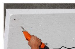
Taglio più veloce, pulito e senza sforzo dell'isolante in polistirene espanso ed estruso (P.S.E. e X.P.S.). Senza polvere. Sistema di ventilazione che consente un uso continuo dell'apparecchio. Potenza: 320 W. Certificato CE. Fornito in valigetta di plastica con :- 1 lama 200 mm- 1 spazzola metallica- 1 chiave di fissaggio per lama
