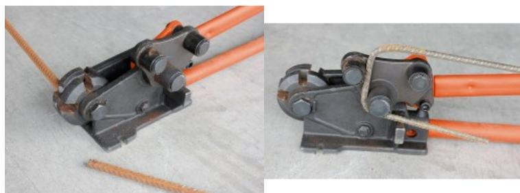
Per tagliare e piegare le barre d'armatura. Doppia funzione: cesoia e piegatrice. Diametro massimo di taglio: 18 mm. Diametro max di piegatura: 16 mm.
