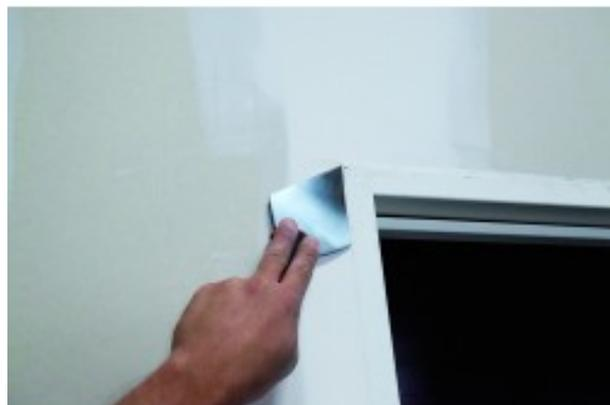
Ideale per finizione della zone con accesso difficile. Lama in acciaio inox. Manico bi-materià con testa di metallo.
