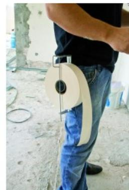
Per mantenere e per erogare il nastro/carta. Può essere agganciato alla cintura. disegno di apertura rapida per sostituire il nastro più facile.
