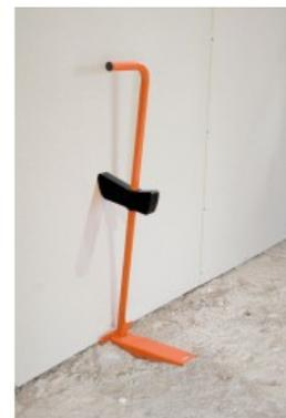
strumento durevole e facile da usare. Permette di lavorare da solo grazie al blocco mobile. Sollevare e bloccare la lastra cartongesso o altri tipi di pannelli in posizione durante l'avvitamento al supporto. Maniglia con orientazione esterno per evitare il contatto diretto con la gamba. bordo smussato per evitare di danneggiare il cartongesso.
