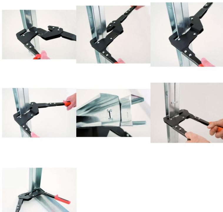
Appositamente progettato per profili schiena contro schiena. Consigliato in caso di pareti sopra 2,50 m di altezza. Punzone con larghezza 90 mm .Max. Capacità: 1 + 1 mm.
