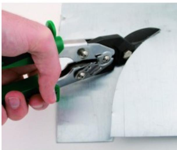
Cisaille à tôle articulée chantourneuse.
