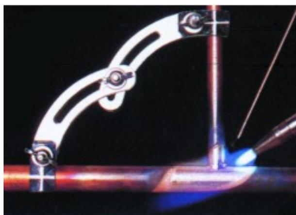
Capacidad de sujeción : tubos de Ø 8 a 30 mm.
